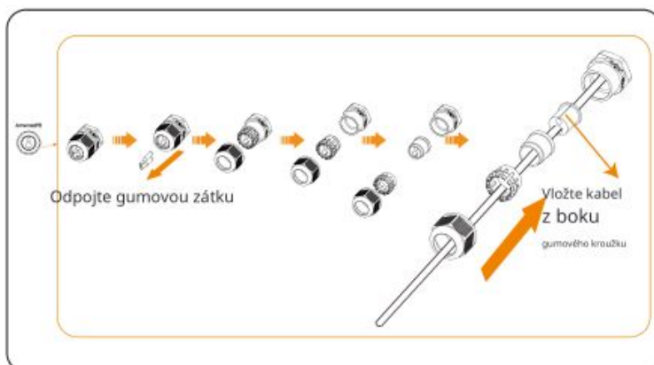
Obrázek 7-86 Protažení kabelu Wi-BR skrz port Antenna&PE
